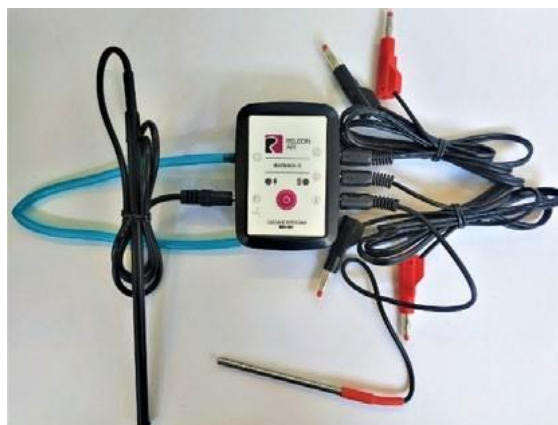
Рис. 9. Беспроводной мультидатчик Releon Air «Физика-5»
